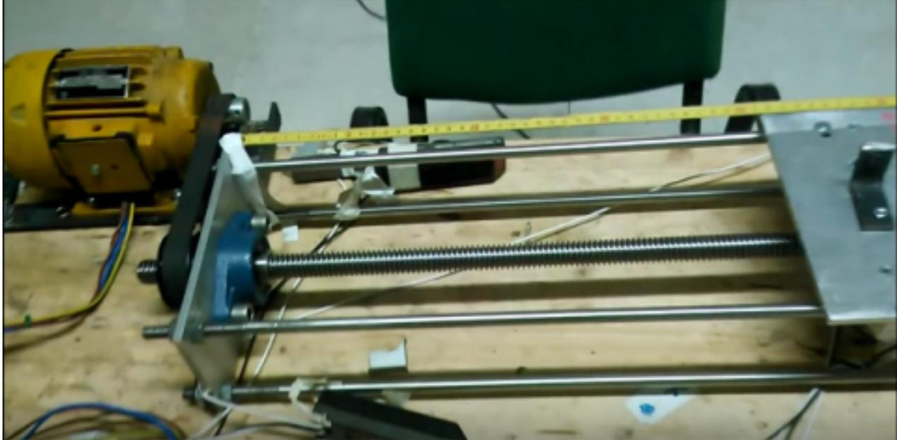
Sistema di controllo retroazionato con regolatore PID per posizionamento cursore millimetrico.
