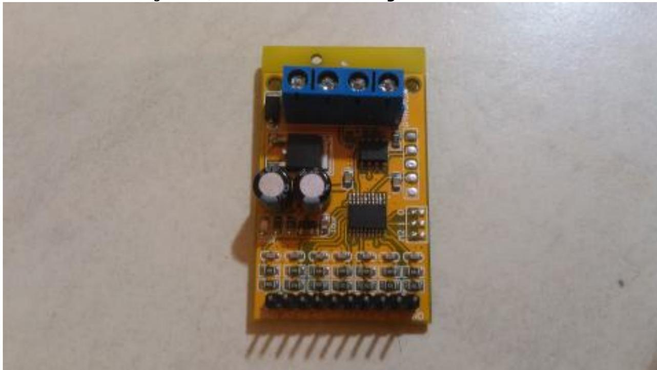
Scheda acquisizione ingressi analogici Modbus RTU con interfaccia RS485.
